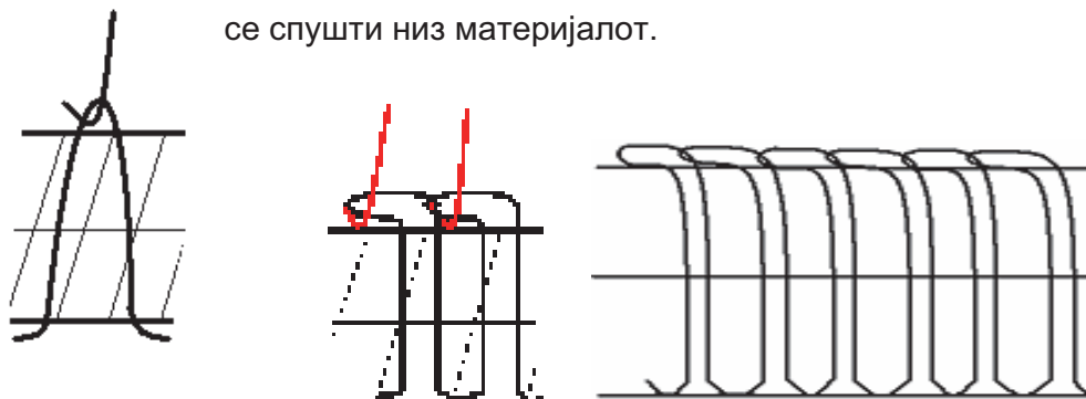
Слика 64. Шема на шиене со игла со форма на кука
