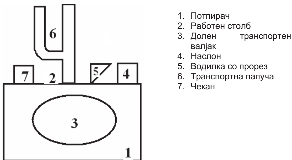
Слика 53. Шематски приказ на машина за подвиткување – Умпук машина
