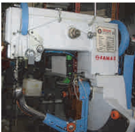
Слика 84. Машина за составување со странично шиење – ДОПЛЕРИЦА
